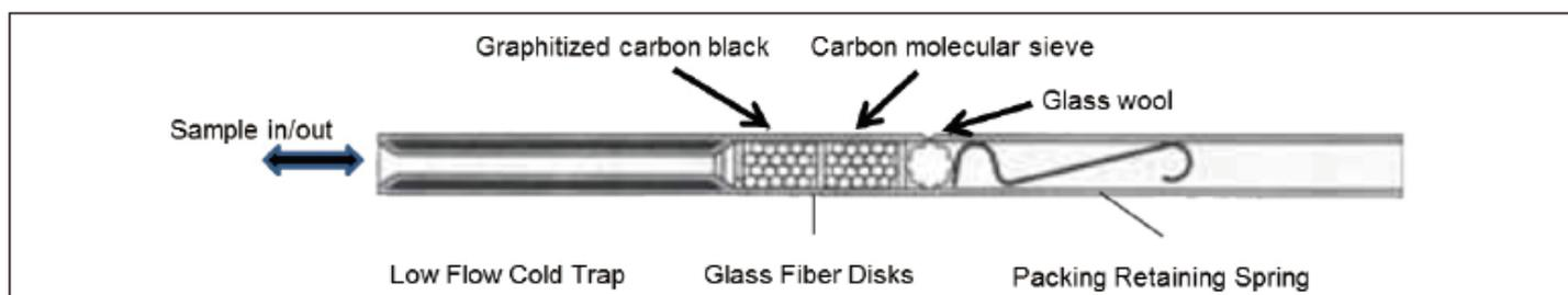
图 1. TurboMatrix 捕集阱结构
