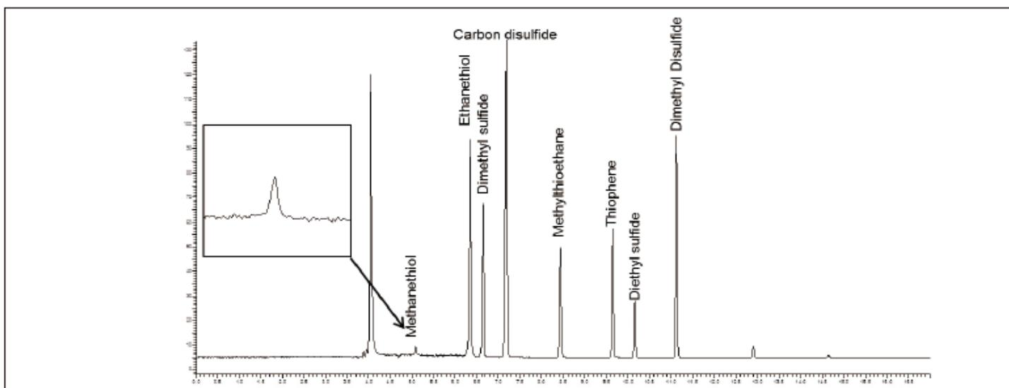
图 2. 8 种硫化物的色谱峰: 5.00 μg/m<sup>3</sup> Methanethiol, 5.02 μg/m<sup>3</sup> Ethanethiol, 4.98 μg/m<sup>3</sup> Dimethyl sulfide, 4.97 μg/m<sup>3</sup> Carbon disulfide, 4.95 μg/m<sup>3</sup> Methylthioethane, 4.97 μg/m<sup>3</sup> Thiophene, 4.89 μg/m<sup>3</sup> diethyl sulfide, 5.16 μg/m<sup>3</sup> Dimethyl Disulfide
